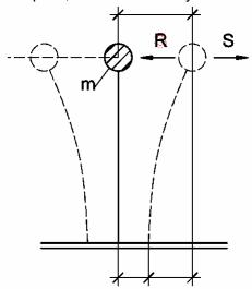
Рис. 1.7. Расчетная модель Н. Мононобе и К.С. Завриева
