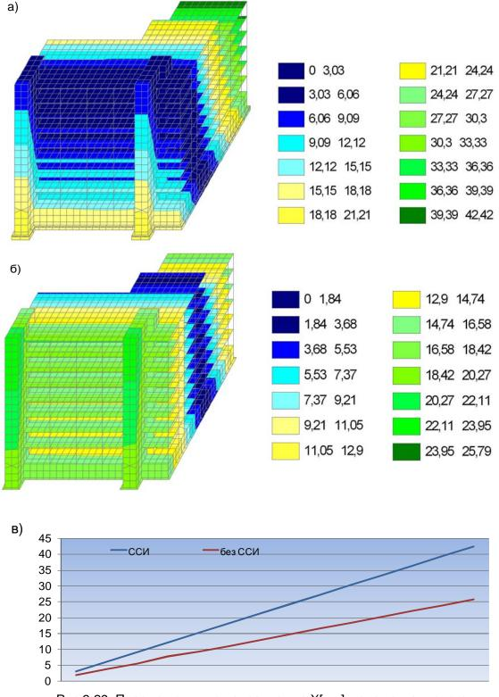
Рис.3.29. Перемещения по направлению X[мм] в элементах конструкции от формы колебаний L10-SD: а) сейсмоизолированное здание; б) не сейсмоизолированное здание; в) график перемещения.
