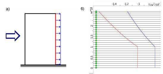
Рис.3.26. а)подветренная поверхность; б) ветровое давление
