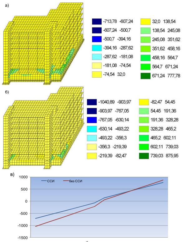
Рис.3.35. Напряжения NY[T/м²] в элементах конструкции от формы колебаний L10 -SD: а) сейсмоизолированное здание; б) не сейсмоизолированное здание; в) график распределения напряжений.
