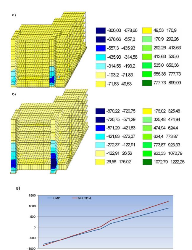
Рис.3.34. Напряжения NX[T/м²] в элементах конструкции от формы колебаний L10 -SD: а) сейсмоизолированное здание; б) не сейсмоизолированное здание; в) график распределения напряжений.
