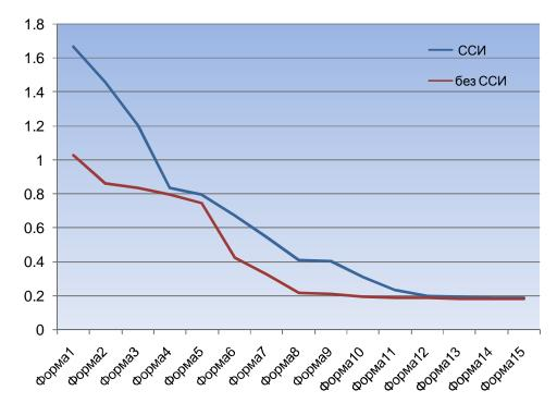
Рис.3.31. Период колебания Т[с] всей конструкции здания с сейсмоизоляцией и без изоляции
