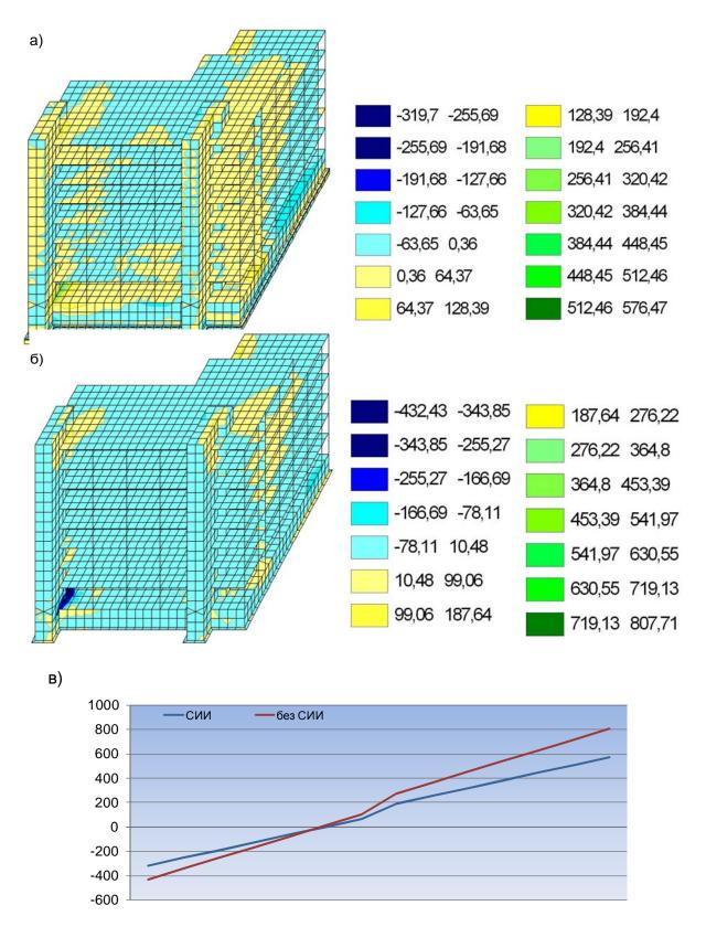
Рис.3.33. Напряжения NY[T/м²] в элементах конструкции от формы колебаний L9 -SD: а) сейсмоизолированное здание; б) не сейсмоизолированное здание; в) график распределения напряжений.
