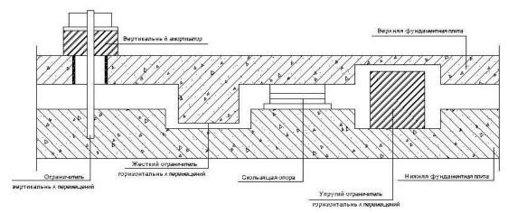
Рис. 3.1. Схема элементов сейсмоизолирующего скользящего пояса.
