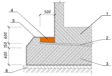
Рис. 3.17. Схема сейсмоизолирующего скользящего пояса.
