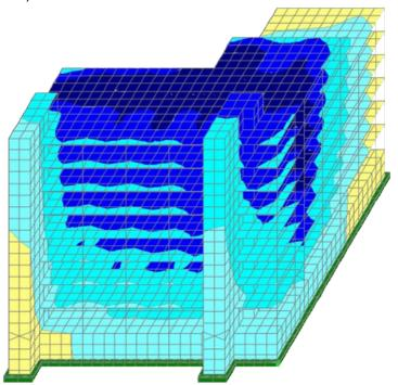
Для подтверждения корректной работы механизма сейсмоизоляции получены результаты перемещений элементов конструкций от суммарных динамических воздействий(рис. 3.27 – рис. 3.30).
