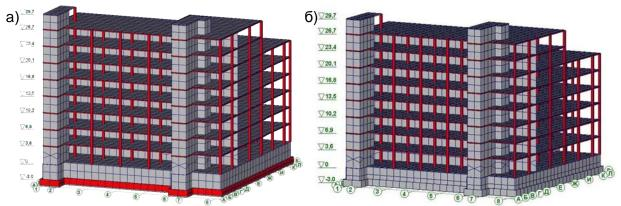
Рис.3.19. Расчетные модели в SCAD
