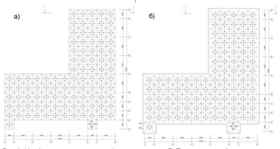
Рис.3.18. а) план уклонов нижней плиты здания; б) План уклонов фундамента.
