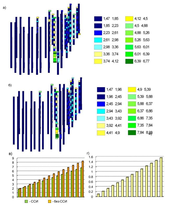
Рис.3.36. Армирование колонны As1 [cм²]: а) сейсмоизолированное здание; б) не сейсмоизолированное здание; в) график армирования колонны As1[cм²] с сейсмоизоляцией и без изоляции; г) разница армирования As1.
