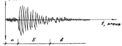
Рис.1. 2. Осциллограмма колебаний поверхности грунта
