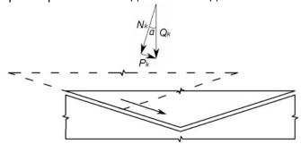
Рис.3.7. Состояние III элементальной сейсмоизолирующой системы
