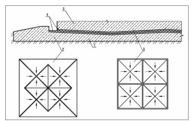
Рис. 3.2. Опорное устройство каркасного здания
