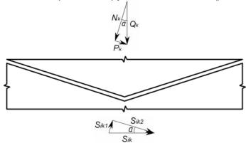
Рис.3.5. Состояние I элементальной сейсмоизолирующой системы Из-за угла α, получим реакция нагрузки действующися на наклонном поверхности по формуле:
