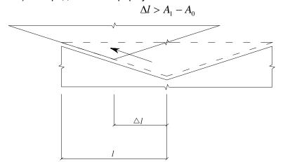
Рис.3.11. Схема относительного смещения ССИ  $\Delta l$  –горизонтальное расстояние скольжения; l – горизонтальная длина наклонной поверхности плиты;
