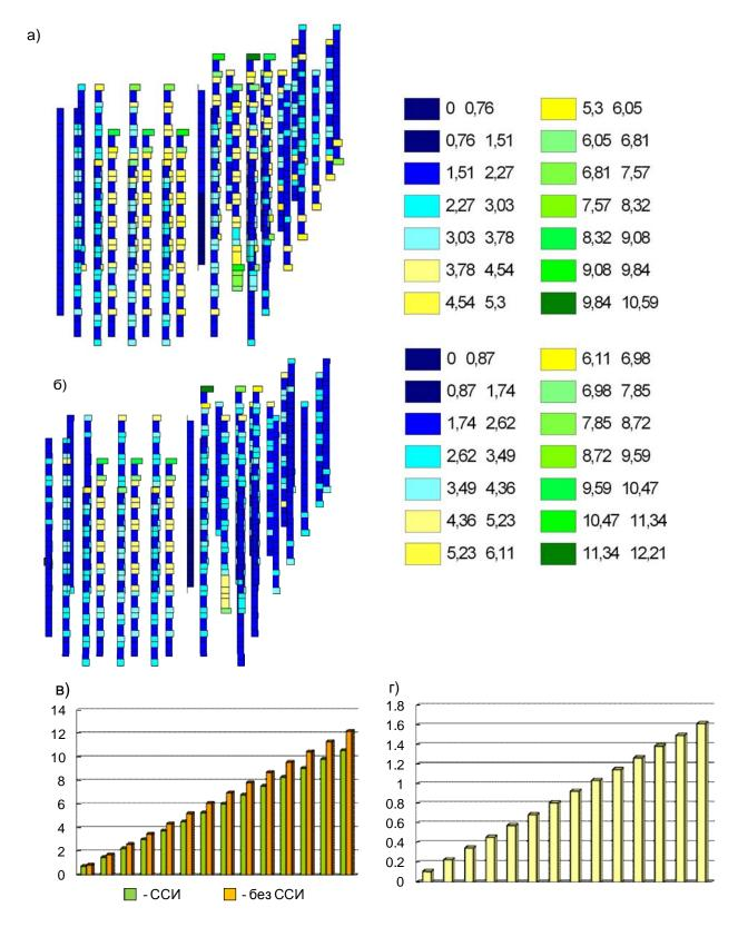
Рис.3.37. Армирование колонны As3 [cм²]: а) сейсмоизолированное здание; б) не сейсмоизолированное здание; в) график армирования колонны As3[cм²] с сейсмоизоляцией и без изоляции; г) разница армирования As3.
