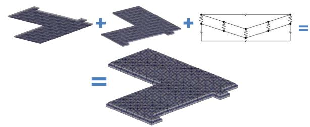
Рис. 3.24. Схема моделирования фундамент скользящим поясом
