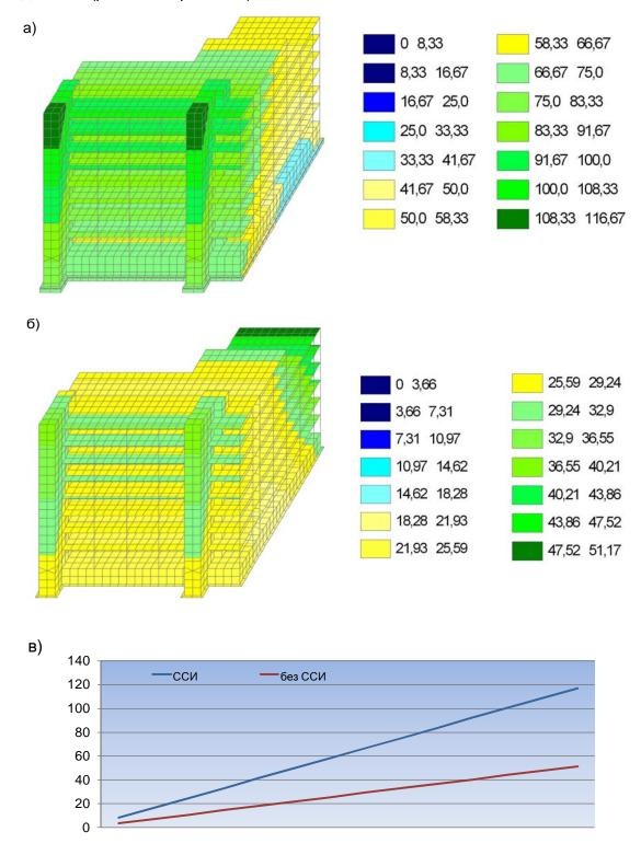
Рис.3.27. Перемещения по направлению X[мм] в элементах конструкции от формы колебаний L9-SD: а) сейсмоизолированное здание; б) не сейсмоизолированное здание; в) график перемещения.
