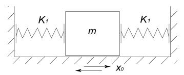
Рис.3.9. Расчетная схема с сухим трением
