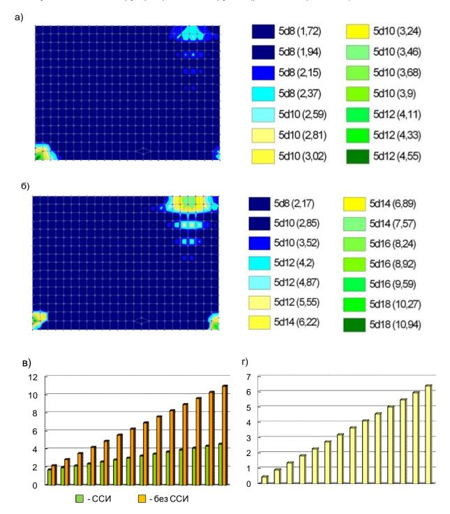
Рис.3.38. Армирование диафрагмы As1 [cм²]: а) сейсмоизолированное здание; б) не сейсмоизолированное здание; в) график армирования диафрагмы As1[cм²] с сейсмоизоляцией и без изоляции; г) разница армирования As1.
