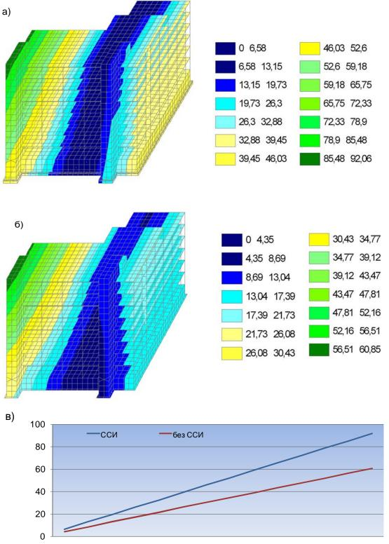
Рис.3.28. Перемещения по направлению Y[мм] в элементах конструкции от формы колебаний L9-SD: a) сейсмоизолированное здание; б) не сейсмоизолированное здание; в) график перемещения.
