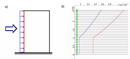
Рис.3.25. а)наветренная поверхность; б) ветровое давление
