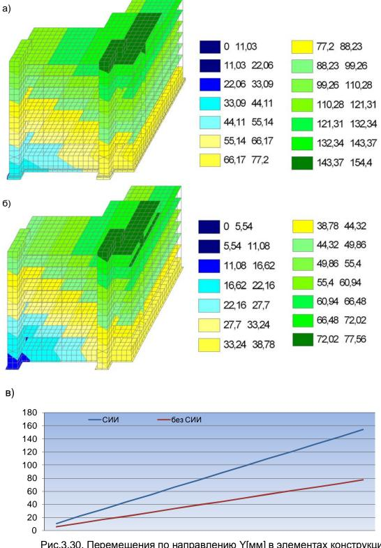
Рис.3.30. Перемещения по направлению Y[мм] в элементах конструкции от формы колебаний L10-SD: а) сейсмоизолированное здание; б) не сейсмоизолированное здание; в) график перемещения.
