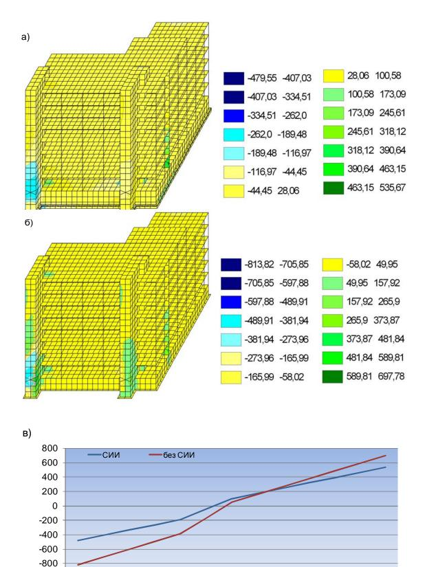
Рис.3.32. Напряжения NX[T/м²] в элементах конструкции от формы колебаний L9 -SD: а) сейсмоизолированное здание; б) не сейсмоизолированное здание; в) график распределения напряжений.
