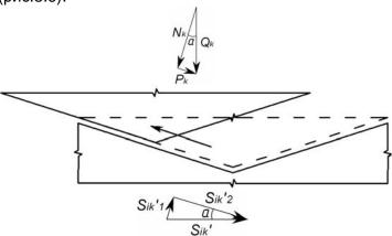
Рис.3.5. Состояние II элементальной сейсмоизолирующой системы
