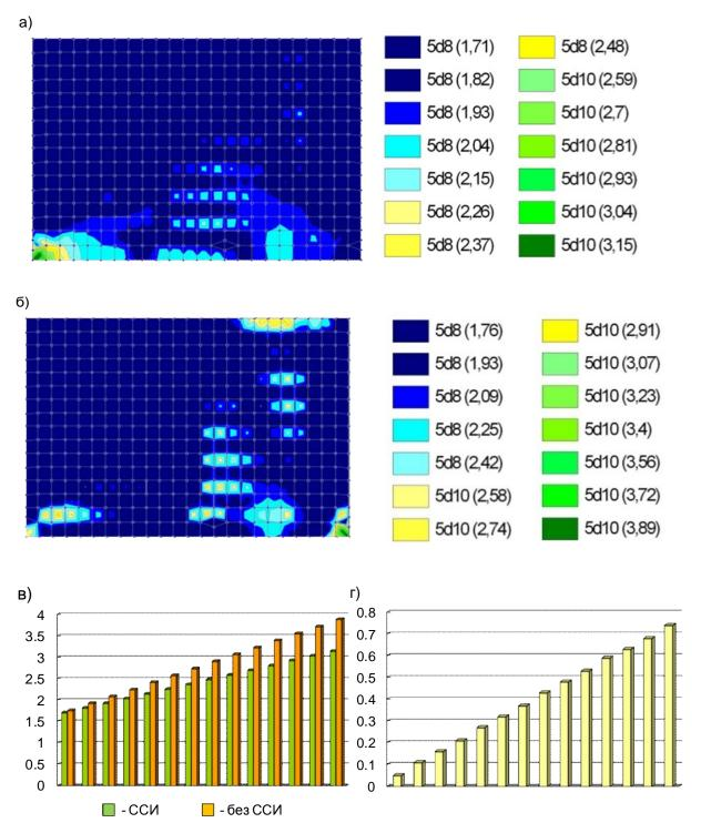
Рис.3.41. Армирование диафрагмы As4 [cм²]: а) сейсмоизолированное здание; б) не сейсмоизолированное здание; в) график армирования диафрагмы As4[cм²] с сейсмоизоляцией и без изоляции; г) разница армирования As4.
