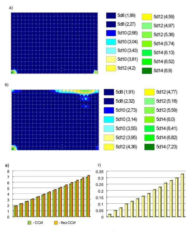
Рис.3.39. Армирование диафрагмы As2 [cм²]: а) сейсмоизолированное здание; б) не сейсмоизолированное здание; в) график армирования диафрагмы As2[cм²] с сейсмоизоляцией и без изоляции; г) разница армирования As2.
