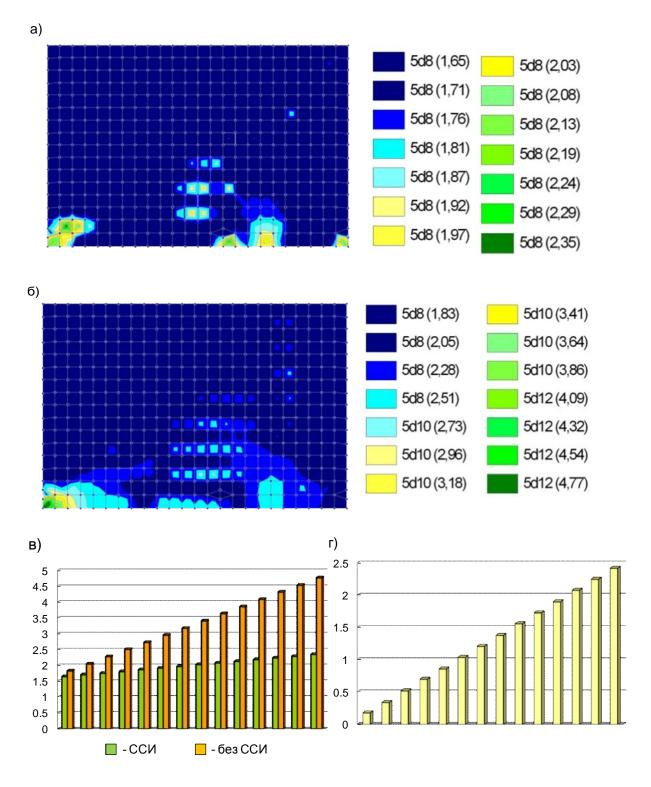
Рис.3.40. Армирование диафрагмы As3 [cм²]: а) сейсмоизолированное здание; б) не сейсмоизолированное здание; в) график армирования диафрагмы As3[cм²] с сейсмоизоляцией и без изоляции; г) разница армирования As3.
