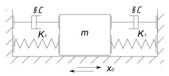
Рис.3.10. Расчетная схема с вязким трением
