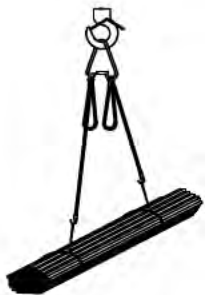
Схема стропування арматури
