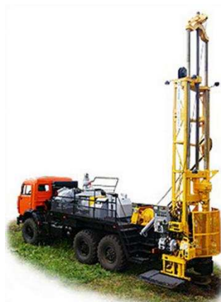
Рис. 7 Буровая установка ЛБУ-50
