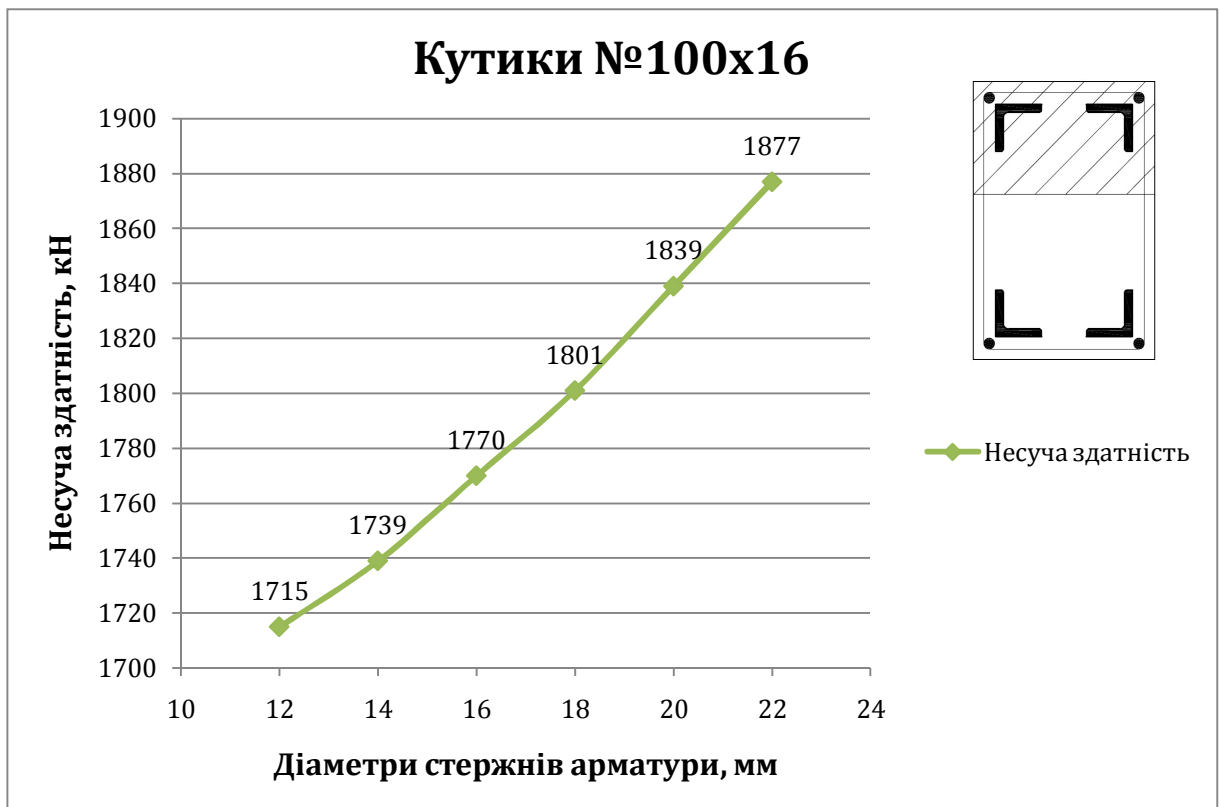
Рис. 4.5. Збільшення несучої здатності при збільшенні площі гнучкої арматури.
