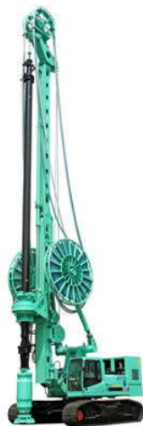
Рисунок 3 – Буровая установка JINTAI SD-12
