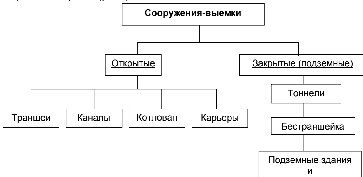
Рис. 4. Классификация земляных выемок
