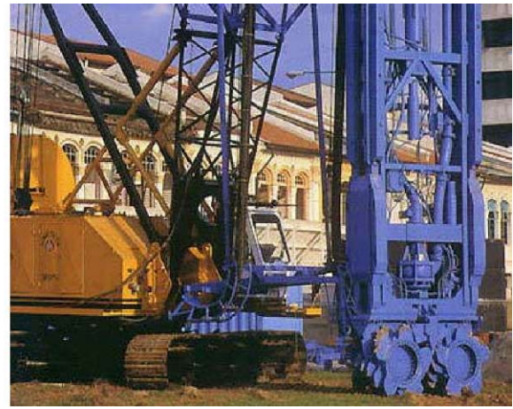
Рис. 11. Навесное оборудование для устройства «стены в грунте».
